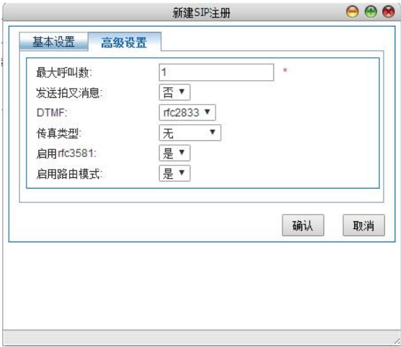
图6-31 SIP注册-新建隐式注册集-高级设置
