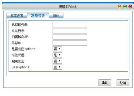
图6-27a 新建SIP-高级设置（适用于接口类型为UNI）
