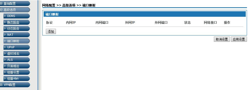
图5-17 端口映射设置
