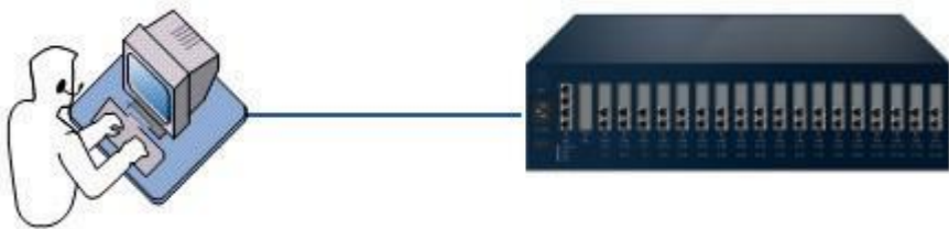
图3-1 连接IP PBX和终端PC
