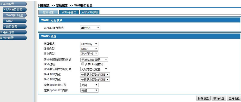
图5-5 DHCP方式获取IP地址
